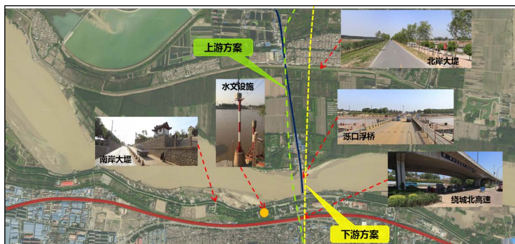
图 8.2-1 穿黄隧道线位控制因素及比选图
