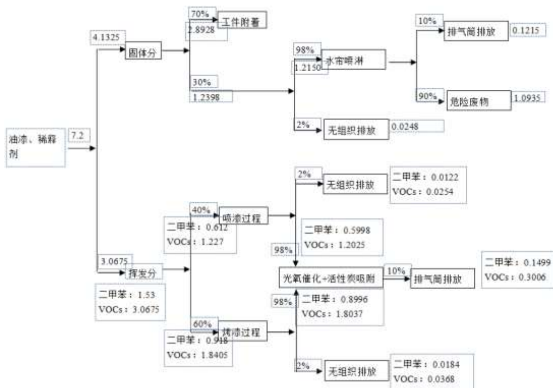
图 4 油漆和稀料物料平衡图
