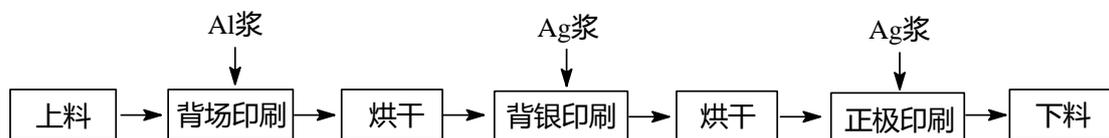
图 3-6 丝网印刷流程
