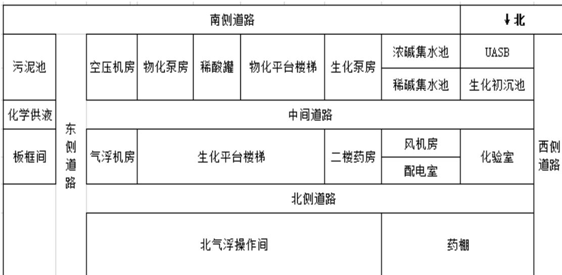
**图 4-1 污水处理站总平面布置图**
